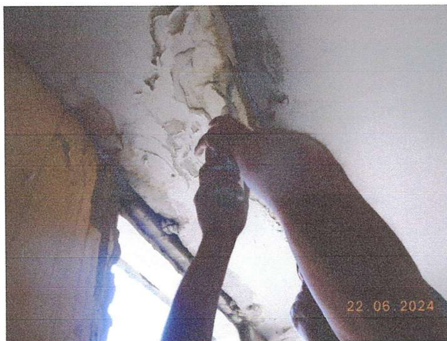
Նկ. 4 Մասնաշենքի երկաթբետոնե կոնստրուկցիաների ամրության որոշման գործընթացը
